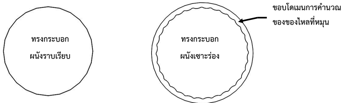
ภาพที่ 3.11 การระบุเงื่อนไขขอบแบบผนังสำหรับปัญหาทรงกระบอกผนังแบบ (ก) ราบเรียบ และ (ข) เซาะร่อง
