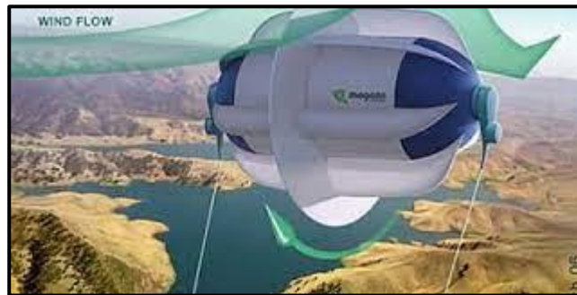
ภาพที่ 1.1 การประยุกต์ใช้บอลูนกังหันฮีเลียม (Magenn Power Air Rotor System) (EcoFriend, no date)
